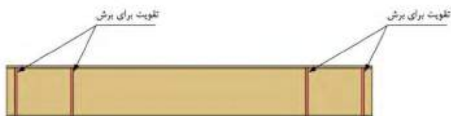
شکل ۱۴-۷۴- ورق سخت‌کننده عمود بر صفحه جان تیر
