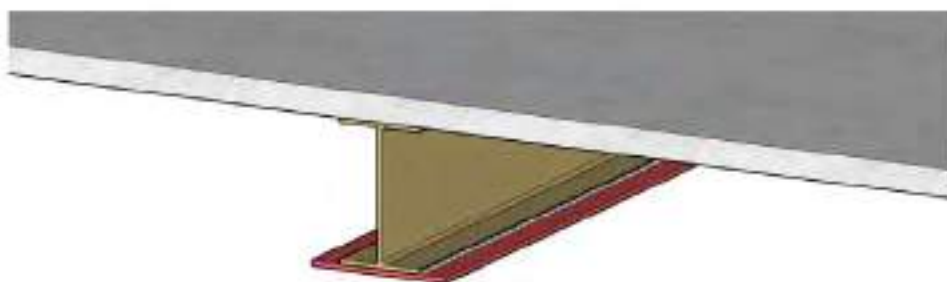
شکل ۱۴-۶۶- افزودن ورق تقویت بال تحتانی تیر با جوش گوشه به تیر موجود
