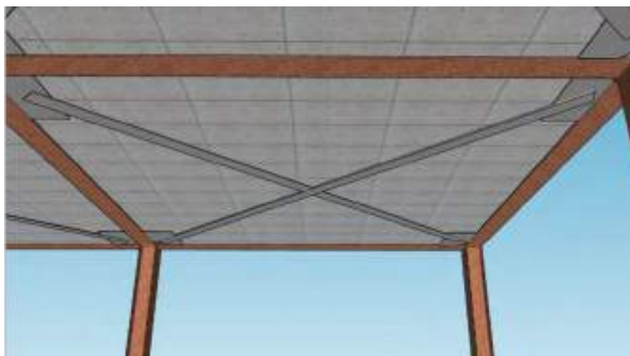
شکل ۱۴-۴۳- تقویت سقف دال با سیستم مهاربندی
