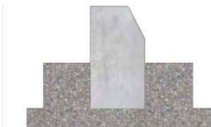
شکل ۱۳-۱۴- نمونه‌ای از اجرای صحیح ماهیچه در طرفین جدول
