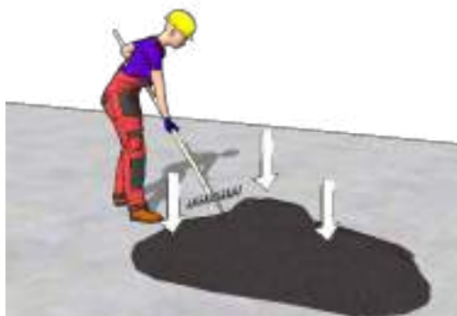
شکل ۱۳-۲- پخش یکنواخت آسفالت با لبه تخت شن کش
