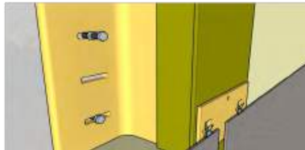
الف- نمونه اجرای اتصال لوبیایی به تیر در اجرای خشک نمای سرامیکی
