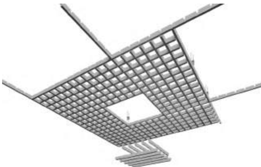
شکل ۸-۸- سقف کاذب گریلیوم مشبک
