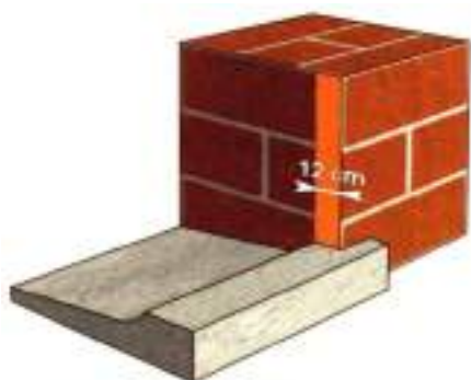
شکل ۱۲-۳۲- مثال آماده‌سازی سطوح محل نصب پنجره و در با تکیه‌گاه‌های بتنی توکار در یک دیوار آجر نمایان
