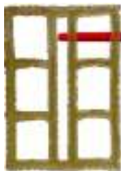
شکل ۱۲-۴۷- لزوم درگیر شدن رول‌پلاگ با حداقل دو بدنه بلوک سفالی
