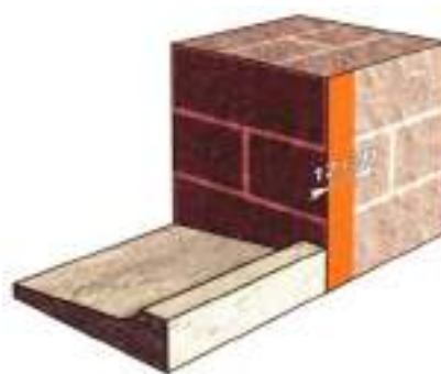
شکل ۱۲-۳۳- آماده‌سازی سطوح یک گشودگی ساخته‌شده از بلوک یا آجر سوراخ‌دار با تکیه‌گاه پیش‌ساخته در حالت نصب روکار
