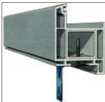
شکل ۱۲-۵۱- اتصال نبشی به قاب با پیچ سر مته‌ای
