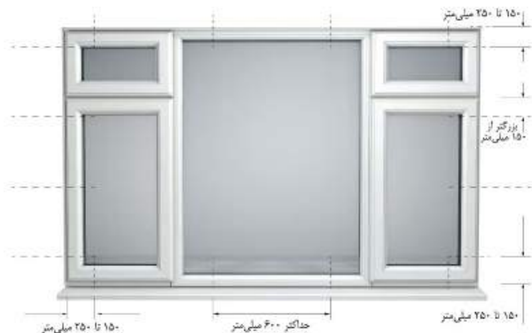
شکل ۱۲-۳۶- محل اتصالات پنجره‌ها و درهای یوپی‌وی‌سی
