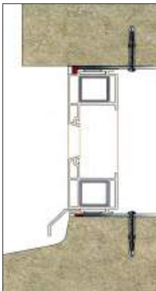
شکل ۱۲-۴۳- نصب غیر مستقیم پنجره و در به دیوار توپر بنایی یا بتنی توسط بست و رول پلاگ
