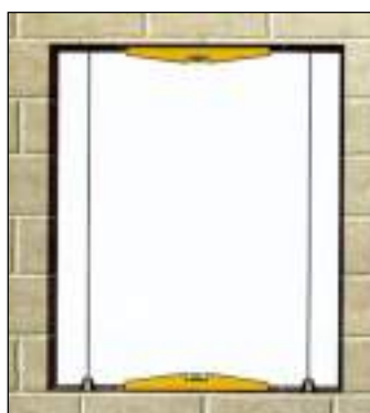
شکل ۱۲-۲۷- اندازه گیری های لازم برای کنترل تراز و شاغول بودن کناره های گشودگی در و پنجره
