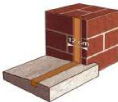
شکل ۱۲-۳۵- آماده‌سازی سطوح یک گشودگی در حالت نصب توکار همراه با پیش‌قاب
