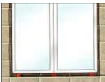
شکل ۱۲-۵۴- جانمایی لاتن‌های بستر چارچوب
