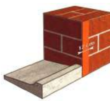
شکل ۱۲-۳۱- مثال آماده‌سازی سطوح محل نصب پنجره و در روکار با زیرپنجره همباد در یک دیوار آجر نمایان
