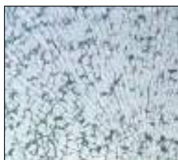
شکل ۱۲-۸۳- شکست در شیشه با عملیات حرارتی کامل
