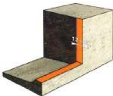
شکل ۱۲-۳۰- مثال آماده‌سازی سطوح نصب پنجره و در با تکیه‌گاه‌های بتنی توکار
