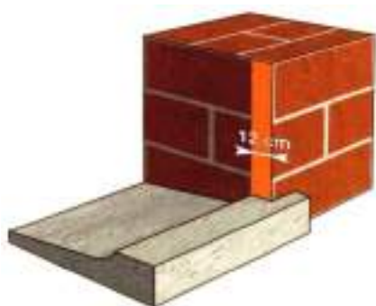
شکل ۱۲-۳۴- آماده‌سازی سطوح یک گشودگی ساخته‌شده از بلوک یا آجر سوراخ‌دار با تکیه‌گاه پیش‌ساخته در حالت نصب توکار
