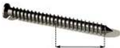
شکل ۱۲-۲۴- نمونه پیچ بدون نیاز به رول پلاگ برای درگیری حداقل ۴۰ میلی‌متر در داخل بتن
