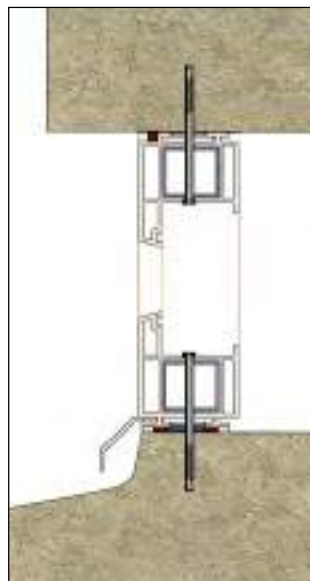
شکل ۱۲-۴۲- نصب مستقیم پنجره و در به دیوار توپر بنایی یا بتنی توسط رول بولت
