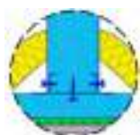
جزئیات و محل اتصال سقف اتصال سقف کاذب به بست امگا (det A)
