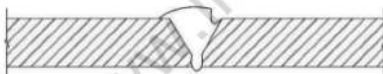
شکل ۱۷-۶-۲ شیار پای جوش
