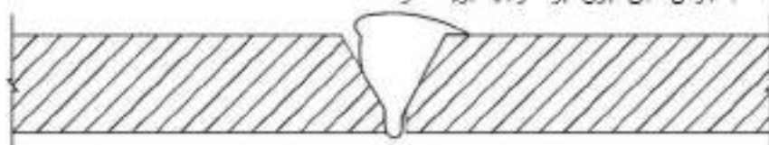
شکل ۱۷-۶-۶ ذوب ناقص در ریشه یا تاج جوش
