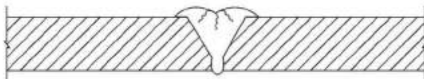
شکل ۱۷-۶-۴ ترک‌های ستاره‌ای در سطح جوش
