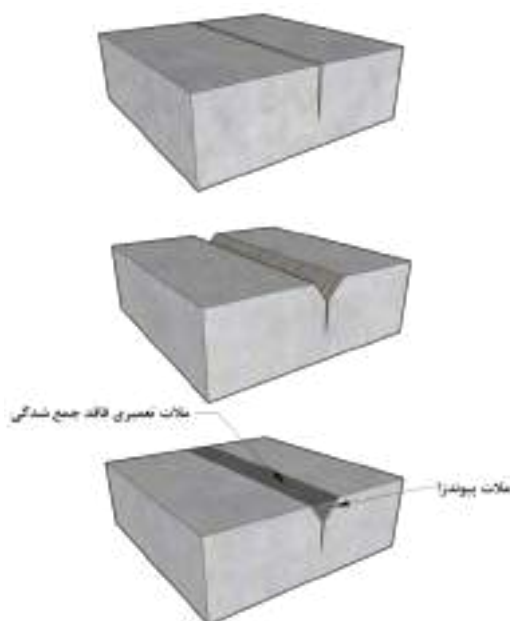
شکل ۶-۲۸- جزئیات اجرایی روش شیارزدن و پرکردن برای تعمیر ترک‌های کم عمق
