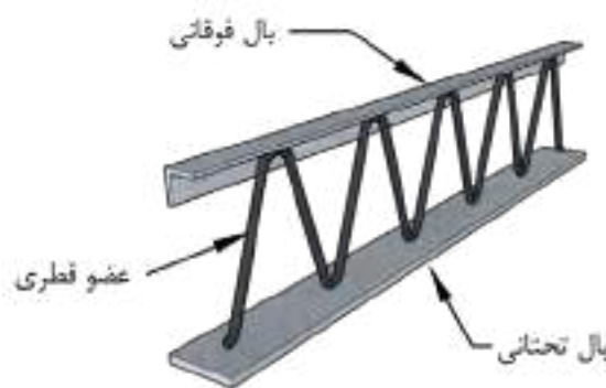
شکل ۴-۲۱- اجزای تیرچه فولادی با جان باز
