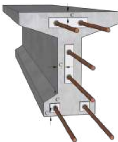
شکل ۶-۱۸- حداقل پوشش بتن بر روی کابل
