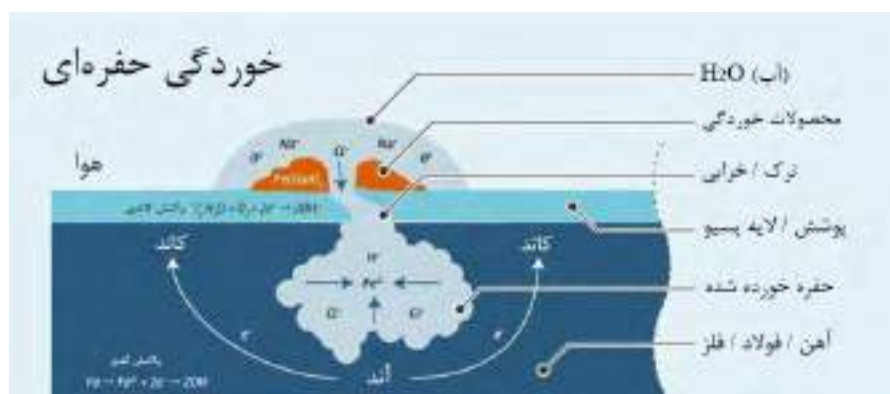
شکل ۶-۷- نمایی از خوردگی حفره‌ای در میلگرد
