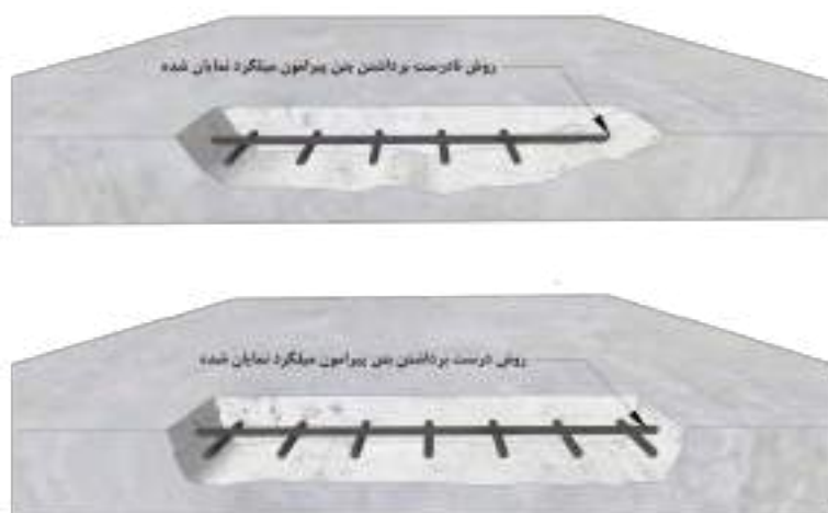
شکل ۶-۳۰- برداشتن بتن کرموشده پیرامون میلگردها
